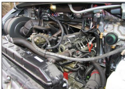
Вот он, экономичный и эластичный в работе 152-сильный турбодизель Cummins ISF 3.8.
