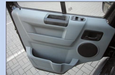
В передних дверях «Соболя» внутри имеются современные пластиковые панели – с кнопками электрорегулировок, вместительными карманами и аудиоподготовкой. В то же время двери «ГАЗели» явно спартанские.
