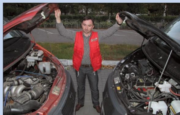
«Соболь» понравился экономичным турбодизелем Cummins в 120 л. с. (на фото справа), а «ГАЗель» – эластичным и более тихим бензиновым двигателем УМЗ в 107 л. с.
