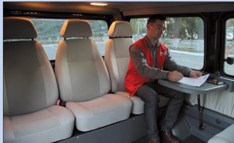
В основном салоне «Соболя», помимо пяти комфортабельных кресел, имеется откидной столик, за которым удобно работать. В пассажирском отсеке «ГАЗели» установлены четыре кресла в ряд. Под ногами – мощный отопитель, в крыше – прозрачный вентиляционный люк.
